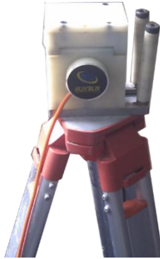
深度记录装置安装
