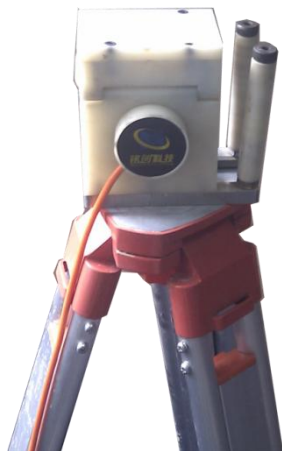
图 4.1.1 深度记录装置安装
